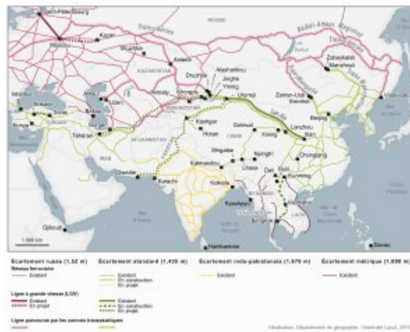
Carte 1. Nouvelles routes de la soie. Le déploiement des projets d'infrastructures de l'« Initiative Belt and Road ». Infrastructures ferroviaires en service, en construction et projetées en Asie.
